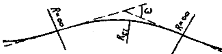
Рис. 1— Определение положения и величин углов поворота трассы в плане при клотоидном трассировании.
